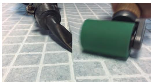
Acabado de la soldadura por solape
